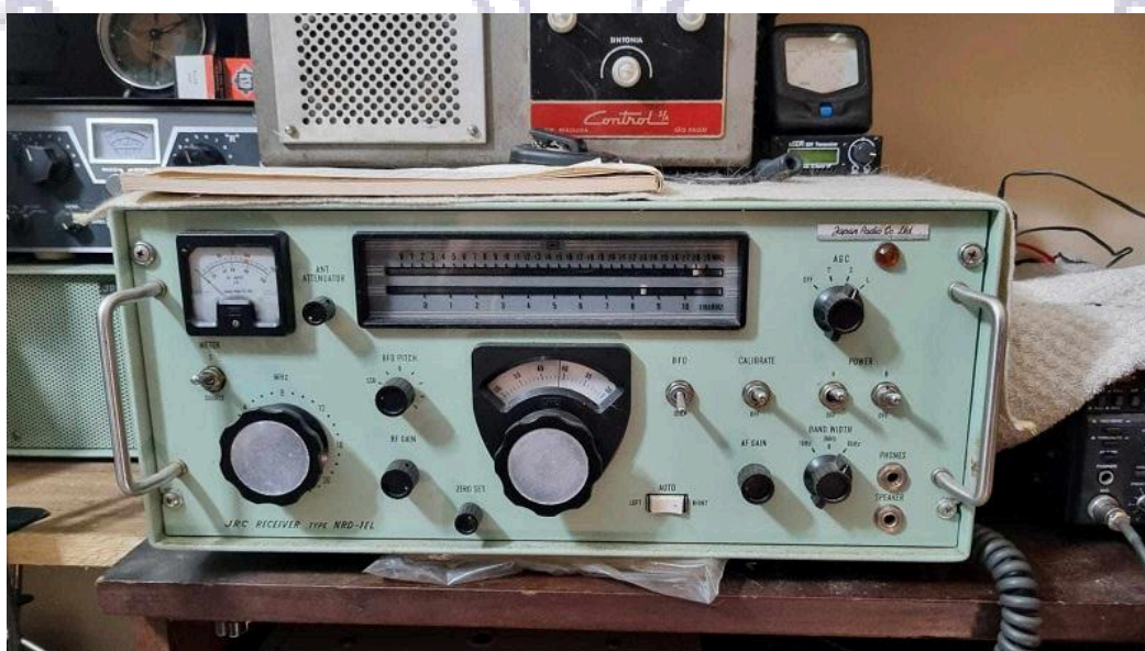
Imagem: Receptor JRC NRD, fabricado em 1968, que pertencia a um barco de pesca japonês, chamado Naikai Maru # 8
