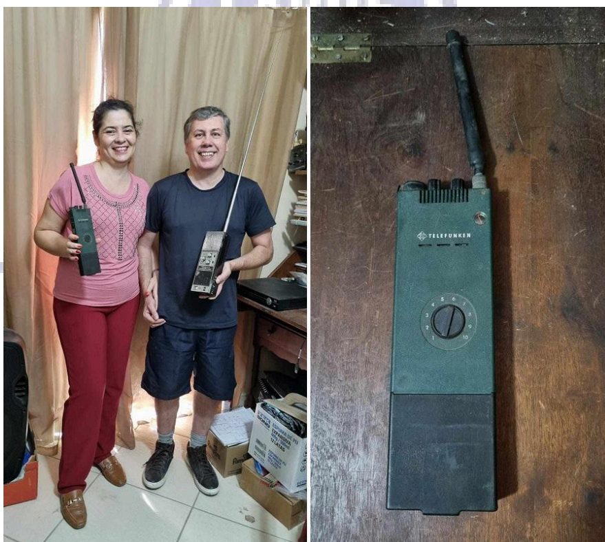
Imagem: Vanessa e Cassiano, junto com alguns walkie talkies, à esquerda podemos ver um interessante rádio portátil Telefunken FuG10, para a faixa de 2 metros, utilizado pela Bundeswehr (força armada da República Federal da Alemanha), na década de 70
