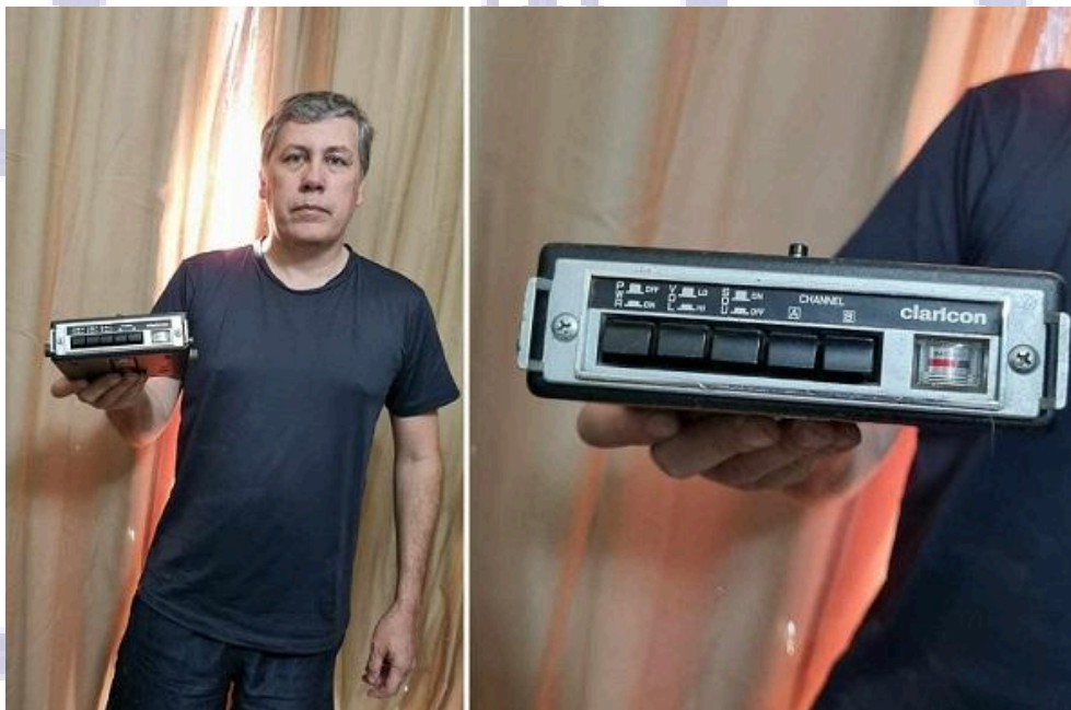
Imagem: Cassiano nos mostra um antigo transmissor de PX de 2 canais dos anos 70, Marca “Claricon”
