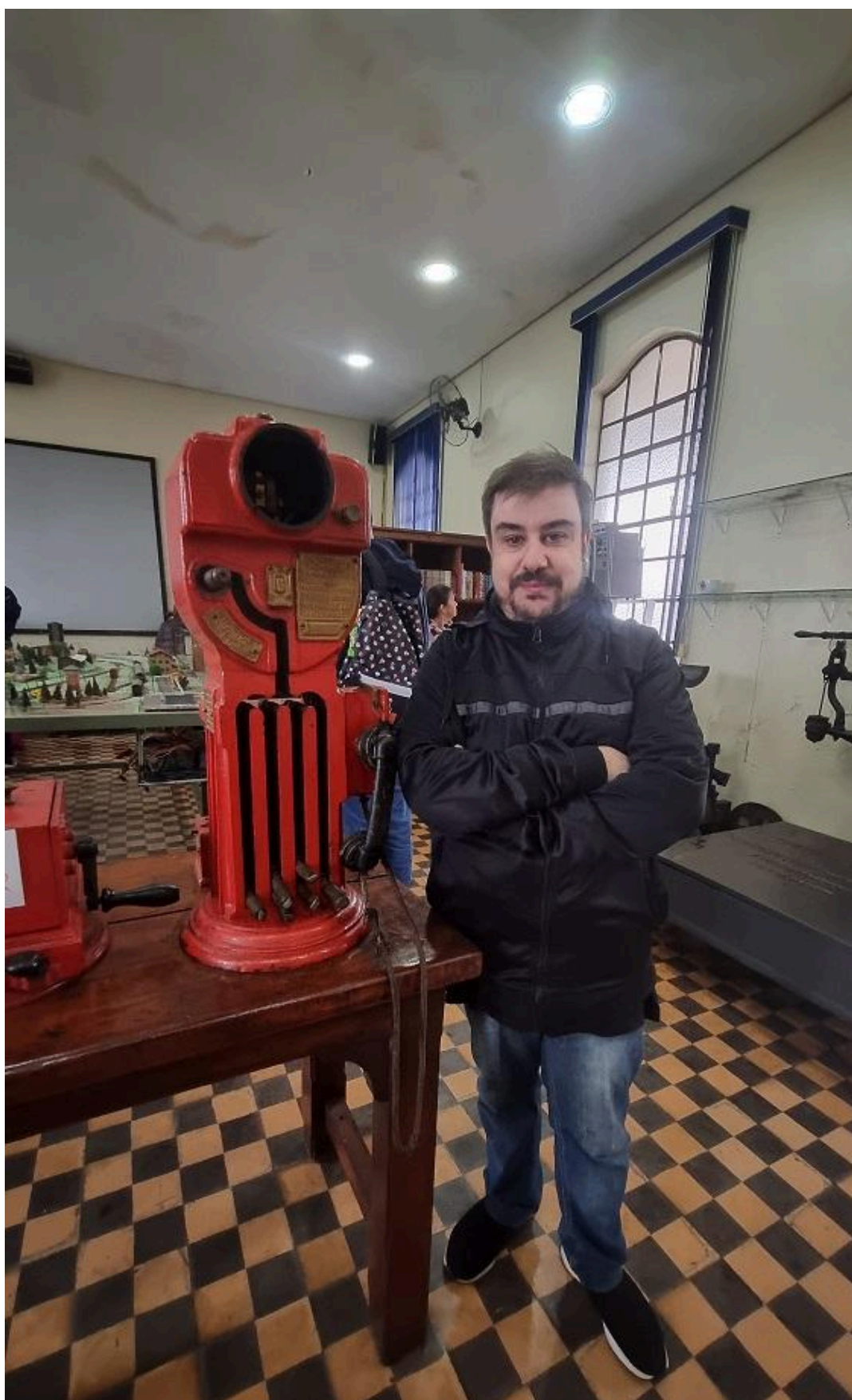
Imagem: Martin Butera (PT2ZDX), junto a um importante sistema de comunicações ferroviárias da época, preparado para a não colisão de comboios vulgarmente chamado de "bastão elétrico"
