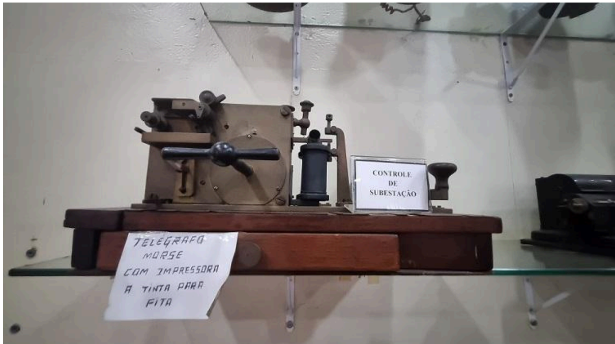
Imagem: Vista bem de perto de um telégrafo impresso, pertencente ao museu “Deusdólar Ferreira Gomes”, grande protagonista da evolução das comunicações ferroviárias no Brasil e no mundo
