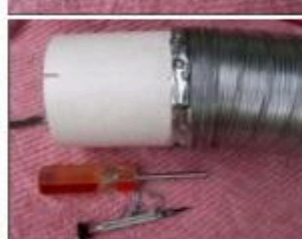
(Arquivo pessoal de Alexandre Grimberg): Podemos ver como as extremidades do tubo de alumínio são fixadas ao tubo de PVC com 12 parafusos de cada lado.
