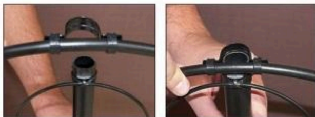
(Arquivo pessoal de Alexandre Grimberg): podemos ver passo a passo a famosa antenna "AlexLoop", como montá-la e como é leve e fácil de transportar.
