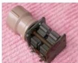
(Arquivo pessoal de Alexandre Grimberg): Em detalhe podemos ver um pedaço de tubo plástico, que ao mesmo tempo manterá o circuito estável e abrigará o capacitor de ar variável em seu interior.
