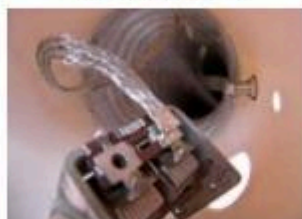
(Arquivo pessoal de Alexandre Grimberg): Em detalhe podemos ver um pedaço de tubo plástico, que ao mesmo tempo manterá o circuito estável e abrigará o capacitor de ar variável em seu interior.
