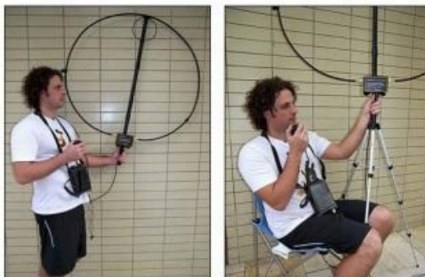
(Arquivo pessoal de Alexandre Grimberg): Podemos ver nas imagens, a melhor forma de operar a antenna "AlexLoop", com o operador sentado confortavelmente em uma cadeira de camping com um dedo no botão de sintonia e a outra mão navegando nos controles do rádio.
