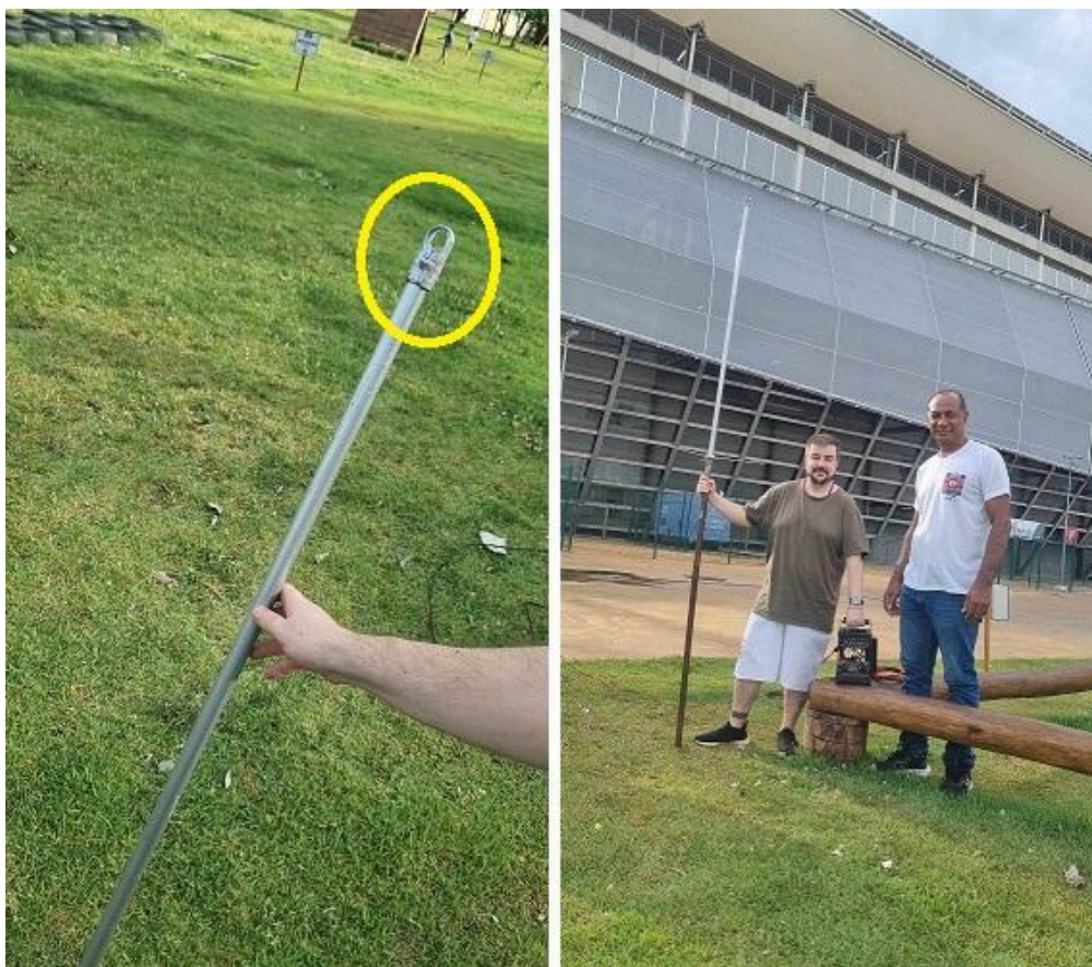
Imagens: Martin Butera (PT2ZDX) e José Sena (PY9SD), juntamente com a antena única que o sistema utiliza tanto na recepção quanto na transmissão, banda dupla (VHF-UHF). A antena possui um suporte simples, mas inovador, que permite, por exemplo, colocar a antena no galho de uma árvore, para ganhar mais altura
