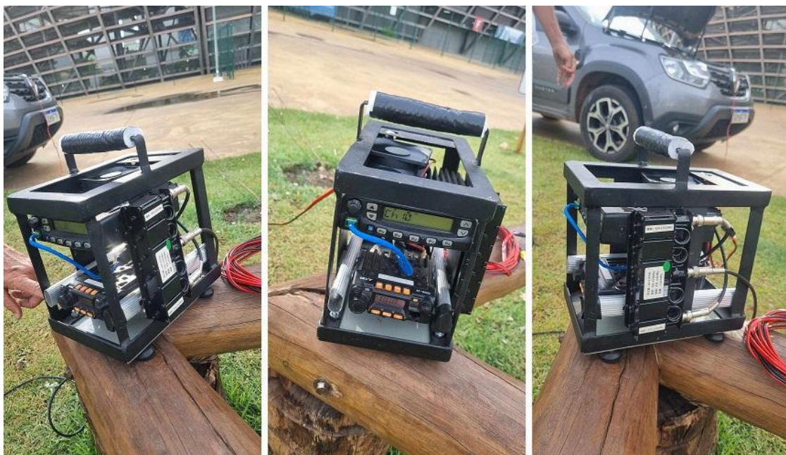
Imagens: Podemos ver de diferentes ângulos o sistema repetidor móvel, desenvolvido pelo colega Antônio Martinho de Jesus (PU9OAA)
