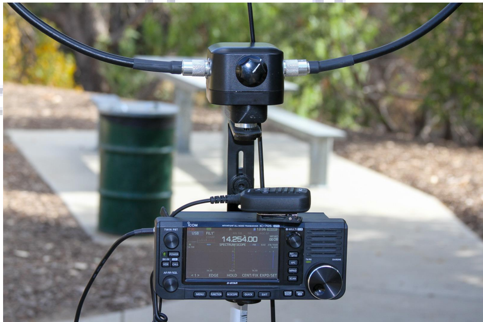
Imagem: Antena de quadro magnético e IC-705 usados por colega Jonathan L (KA6USA)
